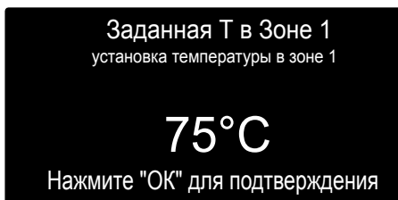
Изменение температуры горячей воды отопления
