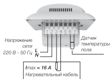
Рисунок 7. Схема подключения терморегулятора к сети
