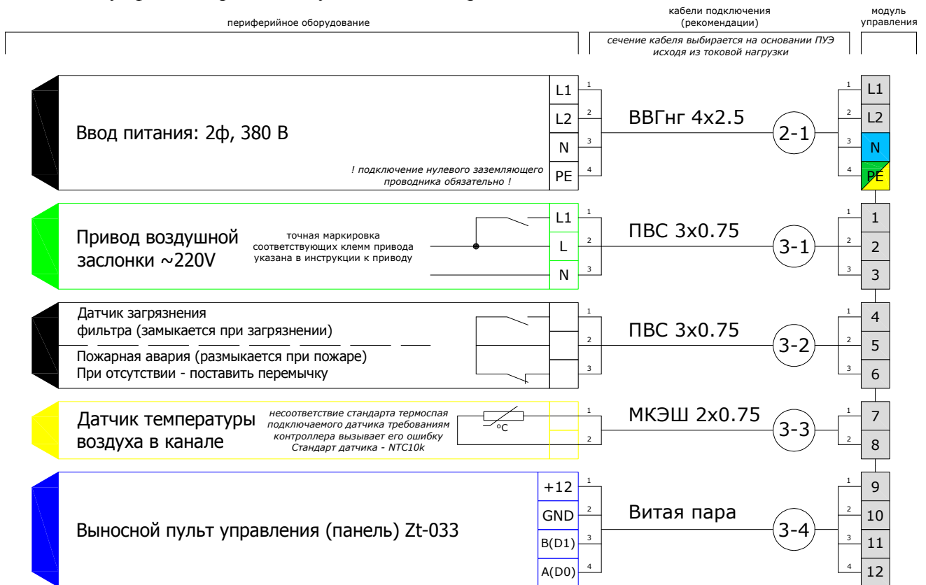
Схема 3. Двухфазные приточные установки с нагревателем мощностью от 4,5 кВт до 6 кВт.
