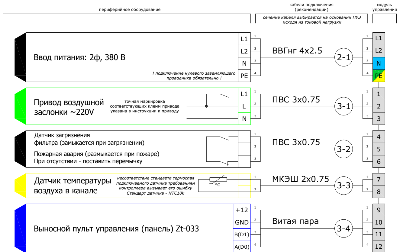
Схема 2. Двухфазные приточные установки с нагревателем мощностью до 4,5 кВт.
