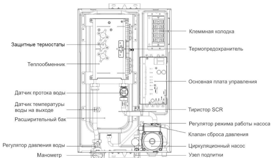
Рис. 2. Схема внутреннего устройства изделия
