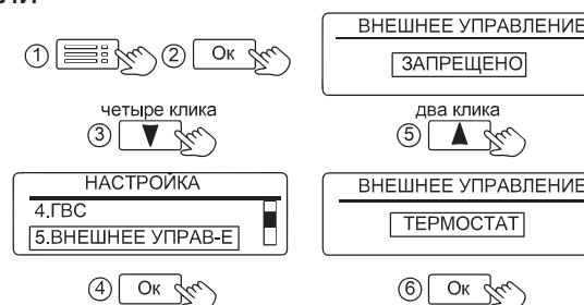
Рисунок 19. Настройка работы от внешнего устройства
