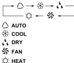
установлен на AUTO (АВТОМАТИЧЕСКИЙ РЕЖИМ РАБОТЫ). В режиме AUTO температура на дисплее не отобразится, в режиме HEAT (ОБОГРЕВ) первоначально установится температура 28°C, во всех остальных режимах первоначально установится 25°C.
