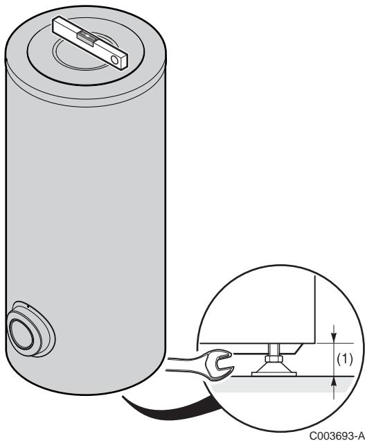
Выравнивание водонагревателя горячей санитарно-технической воды производится с помощью 3 ножек (поставляются в пакете с инструкцией), которые нужно прикрутить к основанию водонагревателя горячей санитарно-технической воды.
