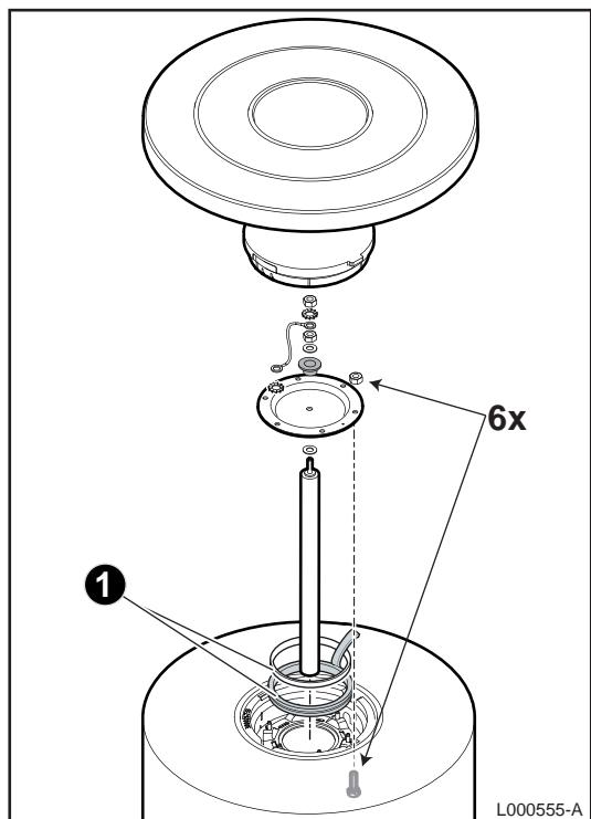
1. Заменить уплотнительную прокладку заглушки и установить ее так, чтобы язычок остался снаружи водонагревателя горячей санитарно-технической воды.
