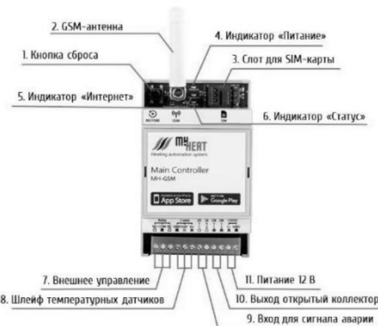
**1. Кнопка сброса.** С помощью этой кнопки выполняются следующие действия:
