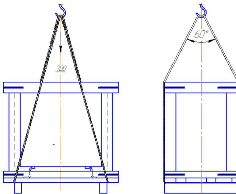
Рис. 12 Схема строповки котла.
