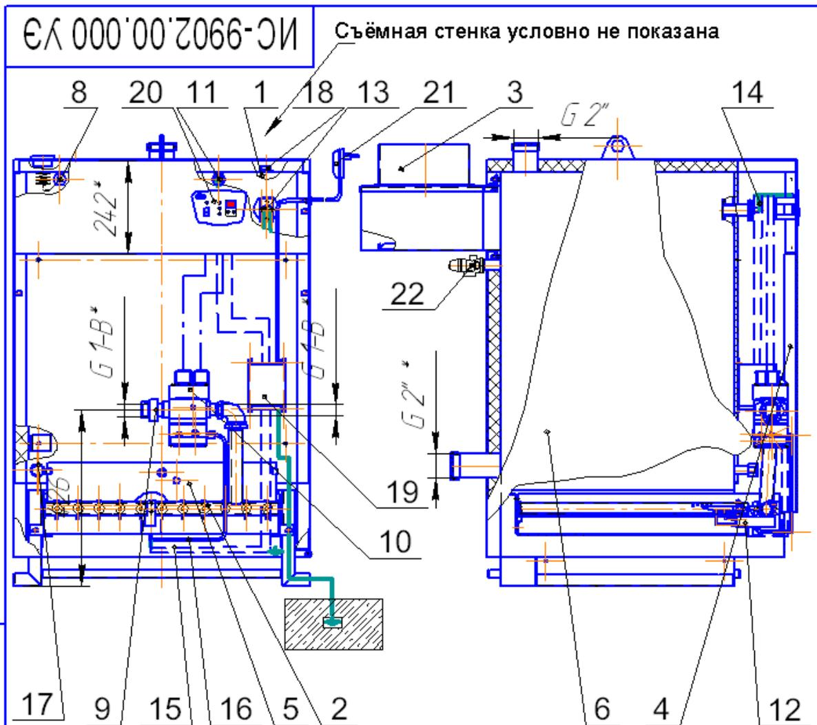
Рис.2 Конструкция котла
