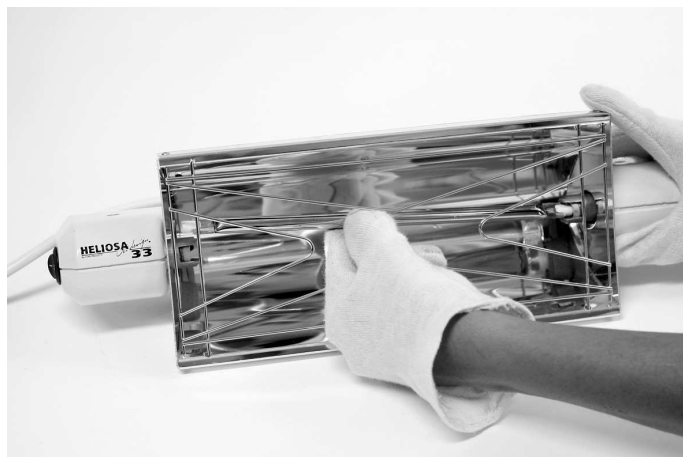
2. ДЛЯ ЗАМЕНЫ ЛАМПЫ СЛЕГКА НАЖМИТЕ НА КОНЕЦ ЛАМПЫ ПОТЯНУВ ЕЕ СЛЕГКА ВПРАВО И ВЫСВОБОДИВ ЕЕ ЛЕВЫЙ КОНЕЦ, А ЗАТЕМ ПРАВЫЙ КОНЕЦ. НАКЛОНИТЕ ЛАМПУ ПОД УГЛОМ 45 ГРАДУСОВ И ВЫСВОБОДИТЕ ЕЕ ЧЕРЕЗ ЗАЩИТНУЮ РЕШЕТКУ
