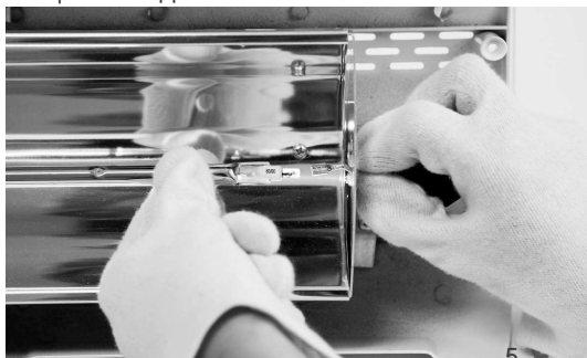
5. СТЯНИТЕ 2 СИЛИКОНОВЫЕ КАПСУЛЫ, ПОКРЫВАЮЩИЕ КОНЦЫ ЛАМПЫ И ОТСОЕДИНИТЕ 2 РАЗЪЕМА ТИПА «ПАПА», ПОДСОЕДИНЯЮЩИЕ ПРОВОДА К ЛАМПЕ. ЕСЛИ РАНЕЕ ИСПОЛЬЗОВАННЫЕ КАПСУЛЫ ИЗНОШЕНЫ, УДАЛИТЕ ИХ АККУРАТНО ОТРЕЗАВ ПРОВОДА У РАЗЪЕМА.
