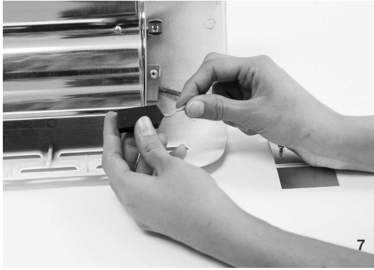
7. ОЧИСТИТЕ ПРОВОДА НА ДЛИНУ 5/6 ММ
