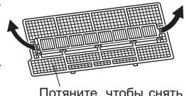
Потяните, чтобы снять с воздушного фильтра
