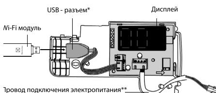
\* Разъем для подключения Wi-Fi модуля
