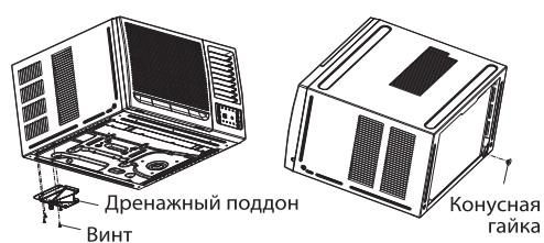
**Задний дренаж:** с помощью конусной гайки заблокируйте нижнее дренажное отверстие и подсоедините водоотводную трубку к заднему дренажному отверстию. Обратите внимание, что потребуется уплотнительное кольцо большего размера, чтобы предотвратить утечку воды.
