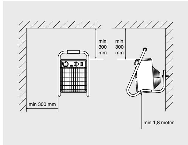
Рисунок 1: Мин. расстояния при подвеске на стену.
