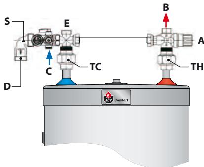
**ПОДКЛЮЧЕНИЕ К КОНТУРУ ОТОПЛЕНИЯ**
